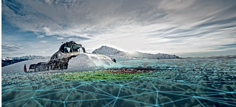
Ein zentrales Element von Prinoth Connect ist die Schneehöhenmessung.
